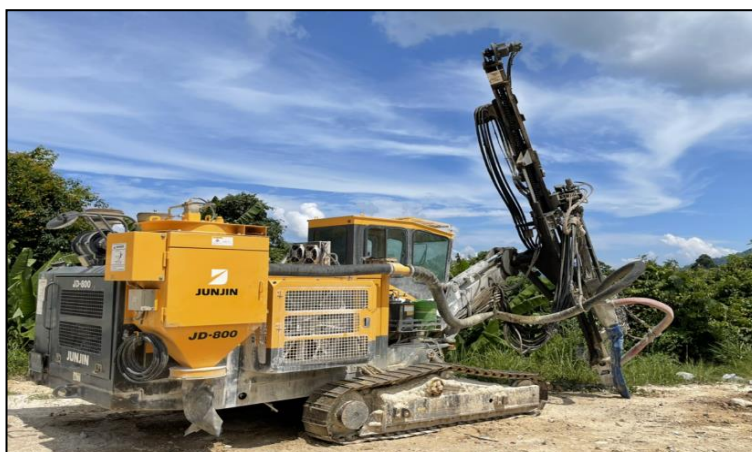
รูปที่ 2.16 โครงการใช้รถเจาะไฮดรอลิกยี่ห้อ Junjin ที่มีเครื่องดูดฝุ่นและมีการดูแลให้ใช้งานได้อย่างมีประสิทธิภาพ
