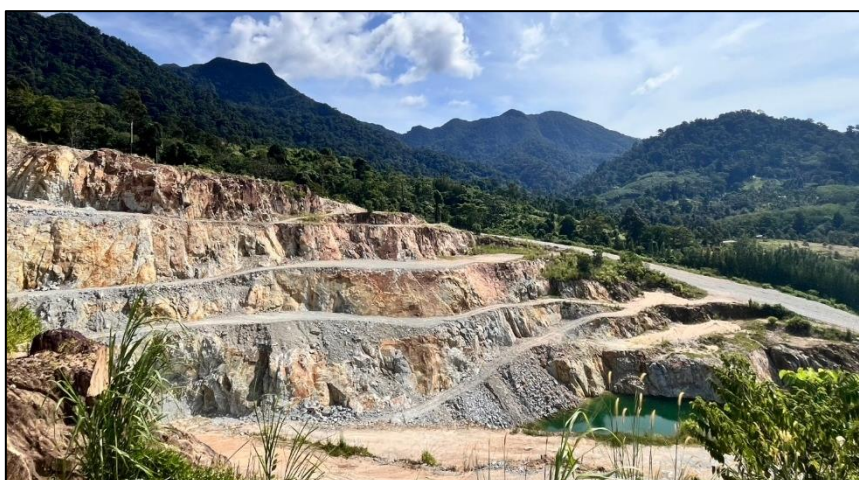
รูปที่ 2.27 โครงการออกแบบหน้าเหมืองให้มีขั้นบันไดให้ปลอดภัยเสมอ
