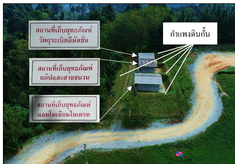
รูปที่ 2.22 มีคลังเก็บดินระเบิดแยกกับคลังเก็บเชื้อปะทุ และมีกำแพงดินกั้นตามแบบกระทรวงกลาโหม
